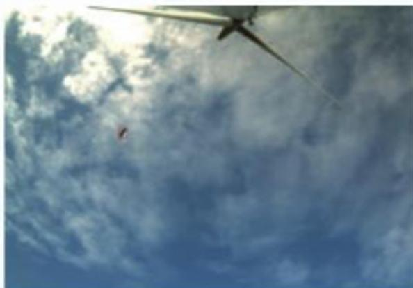
Exemple de point de vue par le système de caméras sur les éoliennes (extrait de Nina 2012 et [www.dtbird.com](http://www.dtbird.com)). Plusieurs caméras sont installées en pied de mât et orientées vers le ciel, celles-ci permettent une observation de l'environnement aérien. Un logiciel de reconnaissance permet la détection d'oiseaux et entraîne le déclenchement d'un signal sonore.
